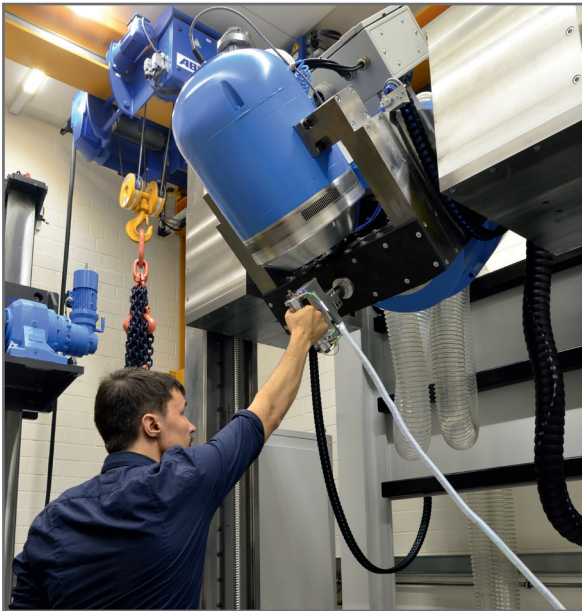
Anwender am AIP bei einer Messung von dynamischen Eigenschaften des Hand-Arm Systems bei Über-Kopf Haltung
