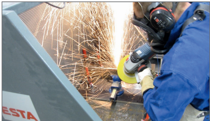
Schruppanwendungen mit Winkelschleifern im IPEK – Power-Tool Testcenter
