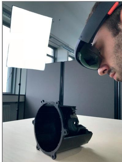
Validierung eines gemischt physisch-virtuellen Prototyps des DEmitL-E-Motors im neuen IPEK XR-Labor (Motorgehäuse bereitgestellt vom Fraunhofer ICT)
