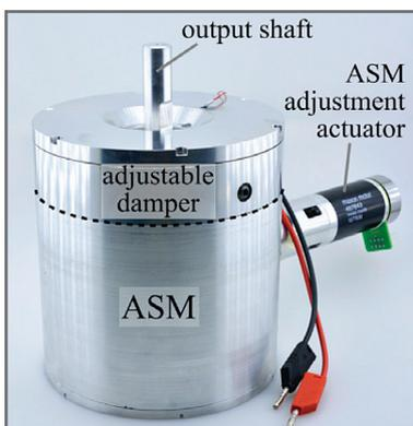
AIE Uno: Einstellbares mechanisches Impedanz-Element des pdIz
