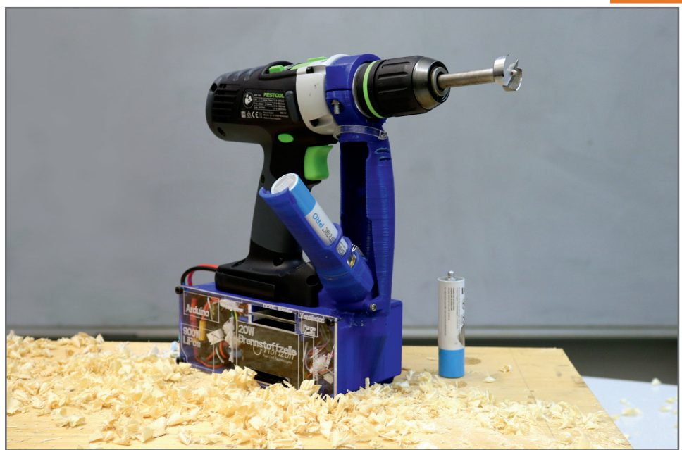
Funktionsfähiges brennstoffzellenbetriebenes IPEK-Konzept-Tool „H2Drill“ zur Potenzialanalyse des Wasserstoffantriebes in handgehaltenen Geräten
