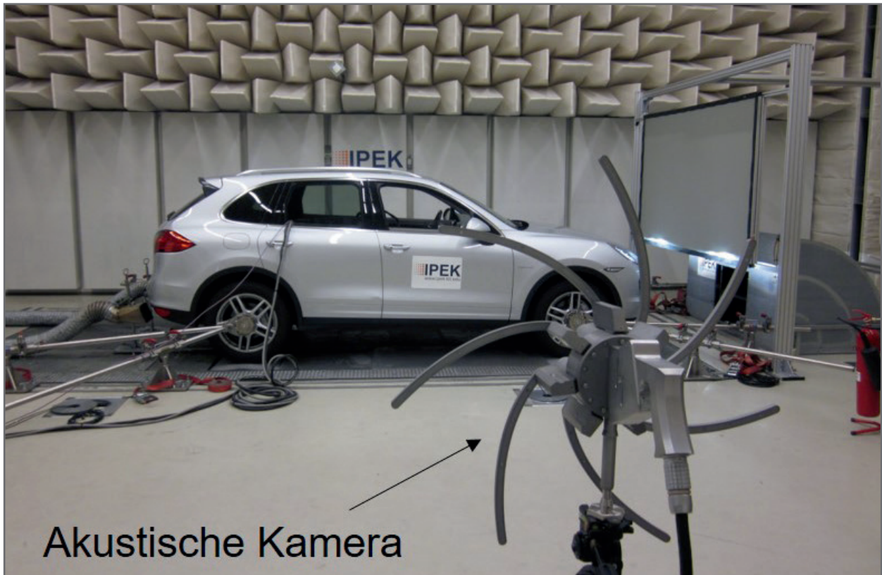
Akustische Kamera mit Prüfaufbau; Visualisierung der akustischen Emissionen eines Fahrzeugs im Fahrbetrieb auf dem Rollenprüfstand zur Untersuchung des NVH-Verhaltens am Gesamtfahrzeug.
