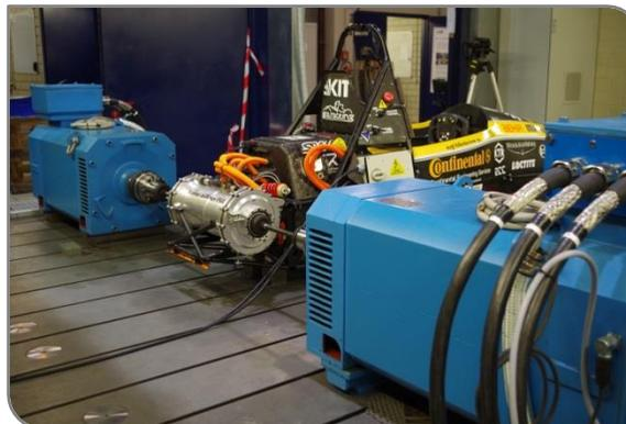
Versuchsaufbau mit einem Elektrofahrzeug
