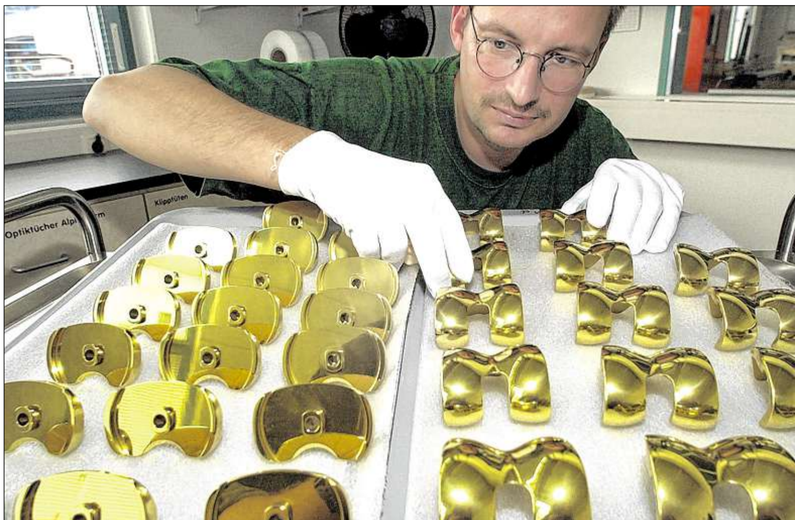
ENDKONTROLLE: Der Mitarbeiter einer Rostocker Firma für medizinische Knochen-Implantate begutachtet künstliche Kniegelenkskomponenten. Sie sind mit Titan-Nitrid beschichtet und damit besonders verschleißfest. Künftig könnten diese Teile auch mit einem Infektionsschutz versehen werden. Foto: dpa
