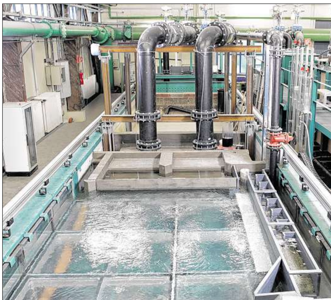
PHYSIKALISCHES MODELL des Unterwassers der Stauanlage Lauffen am Neckar. Der Blick ist auf den Kraftwerksauslass gerichtet, rechts ist der Einstieg in den Fischpass zu sehen. Foto: BAW
