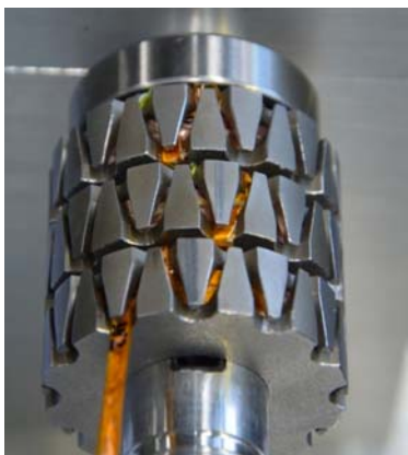
Abbildung 1: Transversalflussmaschine 1 , Eigenmoden eines Elektromotors 2
