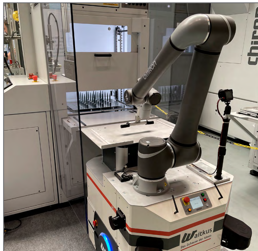
Die intelligente Roboterplattform iQSpan ermöglicht neben der selbstständigen Bestückung und Entnahme von Bauteilen aus der Werkzeugmaschine auch die Qualitätssicherung. Durch Auswertung der gemessenen Qualitätsdaten können Rückschlüsse auf den Fertigungsprozess gezogen und dieser flexibel angepasst werden. Um dies zu erreichen, kann der Roboterarm selbstständig unterschiedliche Werkzeuge (z. B. Sensor und Greifer) aufnehmen und nutzen.
