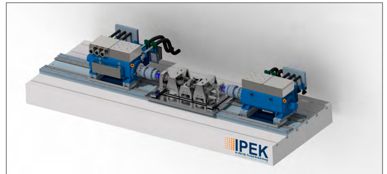
Hochdrehzahlprüfstand zur Analyse von Hochdrehzahlanwendungen mit bis zu 30.000 1/min. Im mittleren Bereich der Prüfumgebung sind drei Getriebe für die Analyse der Leichtbau-Kunststoffzahnräder montiert.
