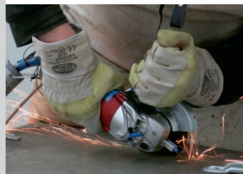
Handversuch mit Seriengerät (mit Messtechnik ausgerüstet)
